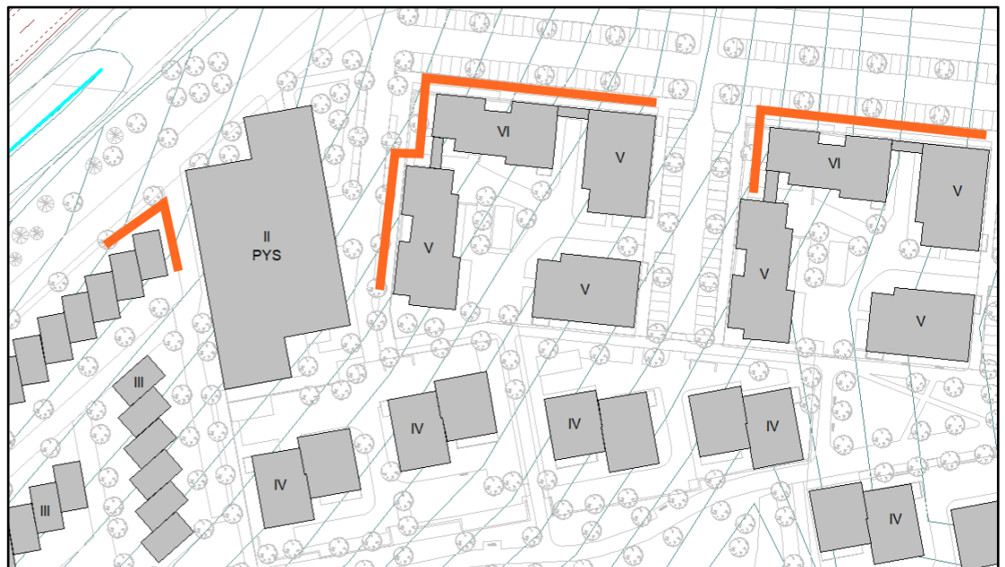
Kuva 9. Julkisivut, joilla päiväjän keskiäänitaso L_{A,eq,7-22} on 65–70 dB
